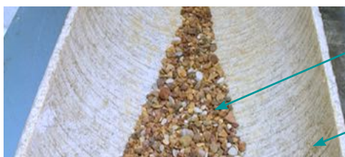
Fig. 12 Testul Darmstadt pentru determinarea rezistenței la abraziune
