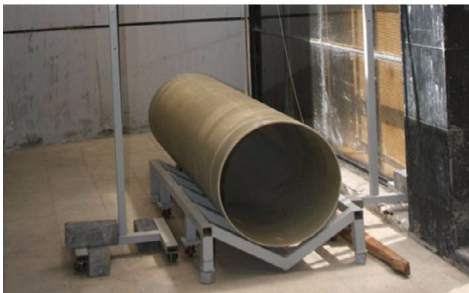
Fig. 17 Conductă fără nisip
