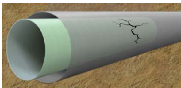
Fig. 23 Reabilitarea conductelor vechi prin relining cu o conductă GRP/PAFSIN
