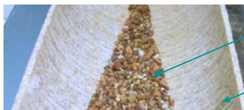
Fig. 12 Testul Darmstadt pentru determinarea rezistenței la abraziune
