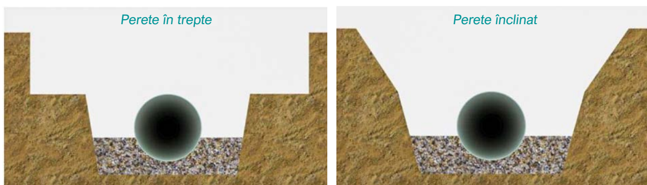
Fig. 3.5 Metode standard pentru stabilizarea peretelui unei tranșee
