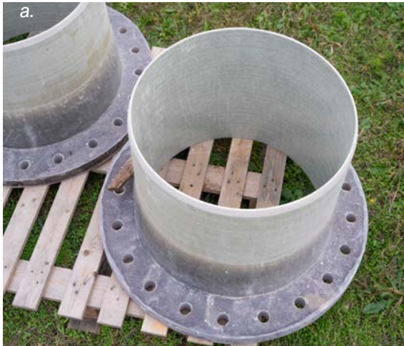
Fig. 4.21 a. Flanșe din PAFSIN, b. Conducte îmbinate cu flanșe din PAFSIN
