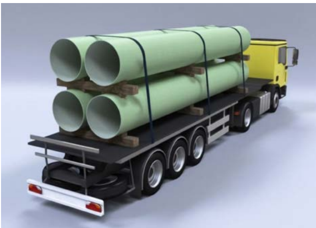
Fig. 2.1 Transportul corect al conductelor de PAFSIN în pachete
