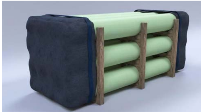
Fig. 2.3 Măsuri pentru protecția capetelor conductelor la transport
