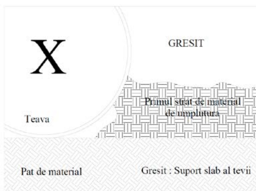
Fig. 3.11 Suport slab al conductei
