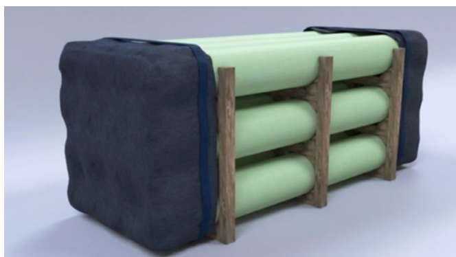
Fig. 2.3 Măsuri pentru protecția capetelor conductelor la transport
