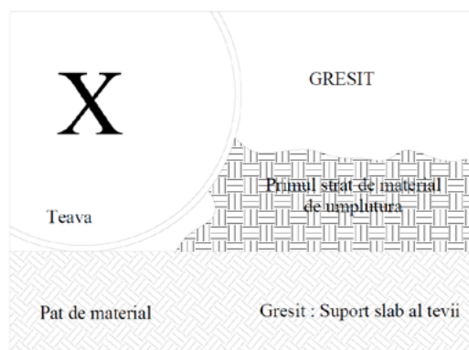
Fig. 3.11 Suport slab al conductei
