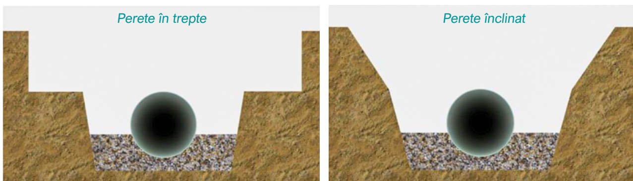
Fig. 3.5 Metode standard pentru stabilizarea peretelui unei tranșee
