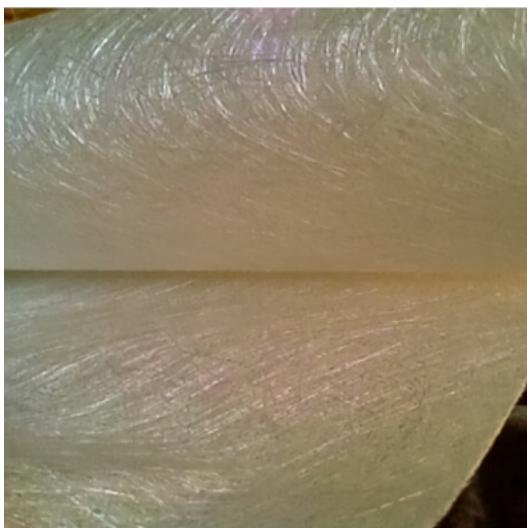
Fig. 4.20 Conductă cu straturi laminate unde: 1 - suprapunerea primului strat 2 - suprapunerea stratului al doilea 3 - suprapunerea stratului al treilea
