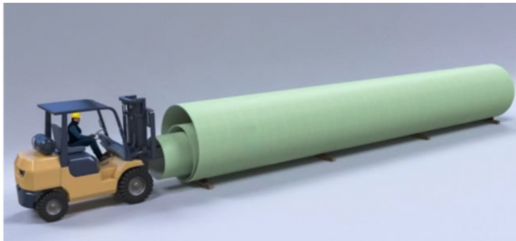
Fig. 2.7 Descărcarea corectă a conductelor din interior, în cazul transportului conductă-în-conductă
